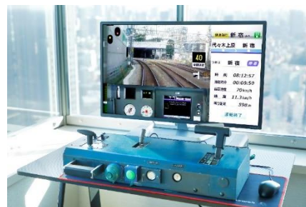
特急ロマンスカー・EXEの運転台機器を用いた小田急かんたんシミュレーター
